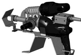
**ACHTUNG** Bei längeren Pausen (ca.15-30min) den Temperaturregler (1) um ca. 2 Positionen zurückstellen (Überhitzungsgefahr des Schweißmaterials in der Schmelzkammer). Ca. 5 min vor Neustart den Temperaturregler wieder auf Schweißposition stellen.
