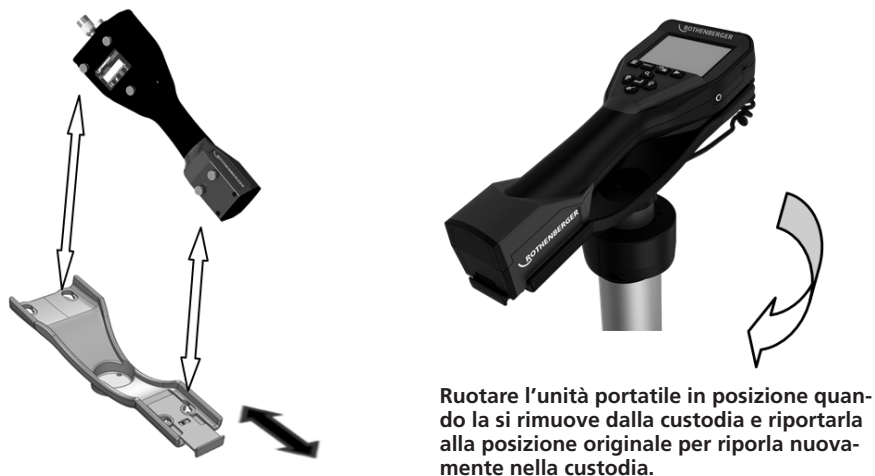
Figura 4 - Installazione dell'unità portatile ROSCOPE 1000/i2000 nella base di montaggio.
