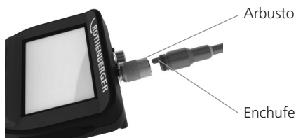
Figura 2 - Cableado (Conector de estilo A negro)
