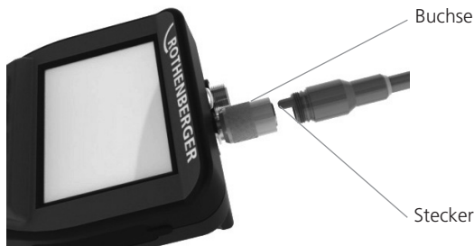
Bild 2 - Kabelverbindungen ( Steckverbindung A, schwarz)
