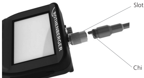
Figura 2 - Collegamenti del cavo (connettore di tipo A, colore nero)
