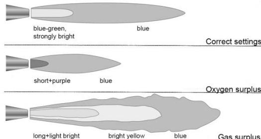
Отрегулировать пламя так, чтобы оно было нейтральным. Это означает, что ядро пламени должно интенсивно гореть сине-зеленым цветом, и его должно обрамлять вторичное пламя более темного синего цвета.
