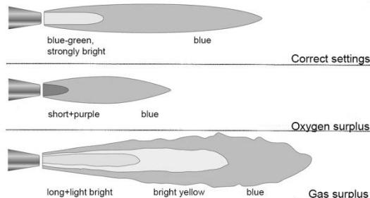
Réglez à présent une flamme neutre, c.-à-d. que le cœur de la flamme (d'un bleu-vert intense) doit se distinguer nettement du bord de flamme bleu foncé (flamme secondaire).
